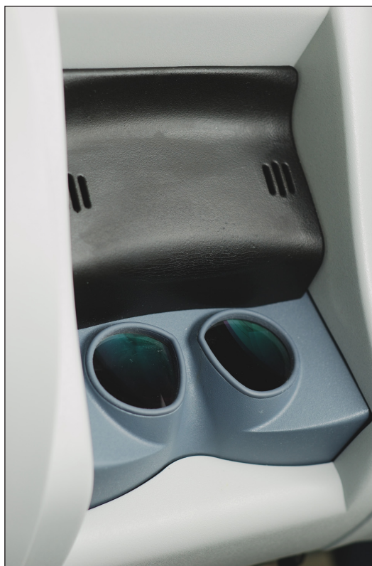
Рис. 5. Стереоскопические окуляры на консоли хирурга
